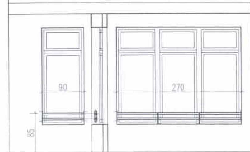
balustrada zabezpieczająca dostęp do okna. l= 90 cm 34 sztuki
