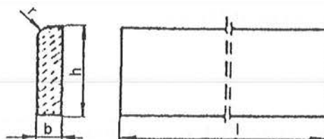
Rysunek 1. Kształt betonowego obrzeża chodnikowego
